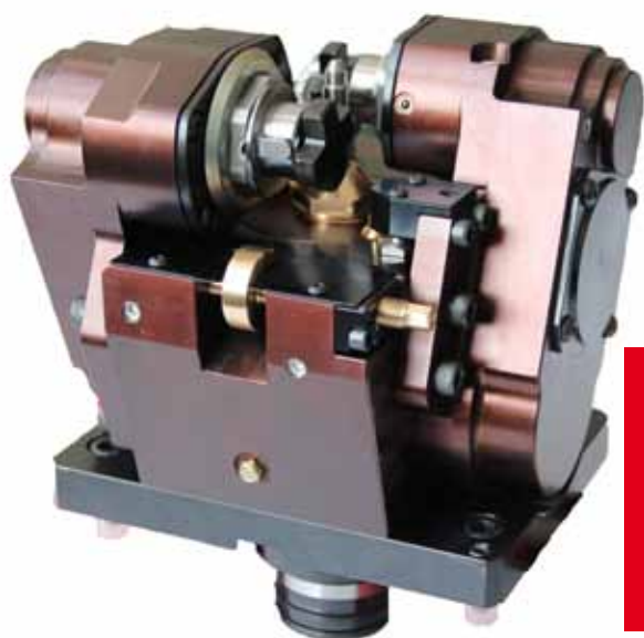
Modulo per fresatura cave su albero settore automotive.
